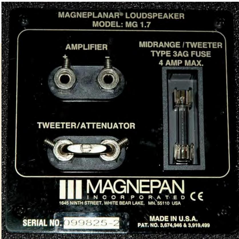
têm a mesma configuração peculiar que se mantém desde há alguns anos, fazendo-se o aperto dos cabos ou terminais de ligação por meio de parafusos do tipo Allan, o que implica o recurso e uma chave de aperto específica, fornecida pela Magneplanar.
