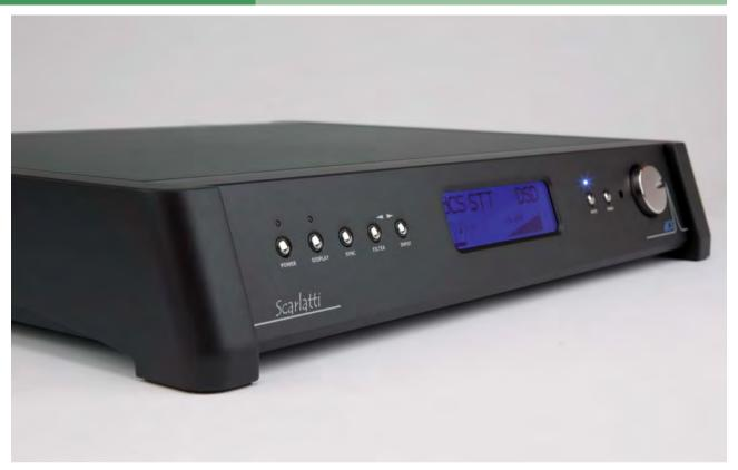
O transporte usa um mecanismo TEAC Esoteric VRDS Neo para recolher informação dos discos. Os dados recolhidos dos CD's são sobreamostrados para a frequência DSD (*bitstream* à razão de 2,822 MS/s), que é o formato SACD, e enviados ao DAC através de uma ligação IEEE 1394 Firewire. A versatilidade é elevada, mas seria maçador e desinteressante estar aqui a descrever todos os tipos de saídas que proporciona.
