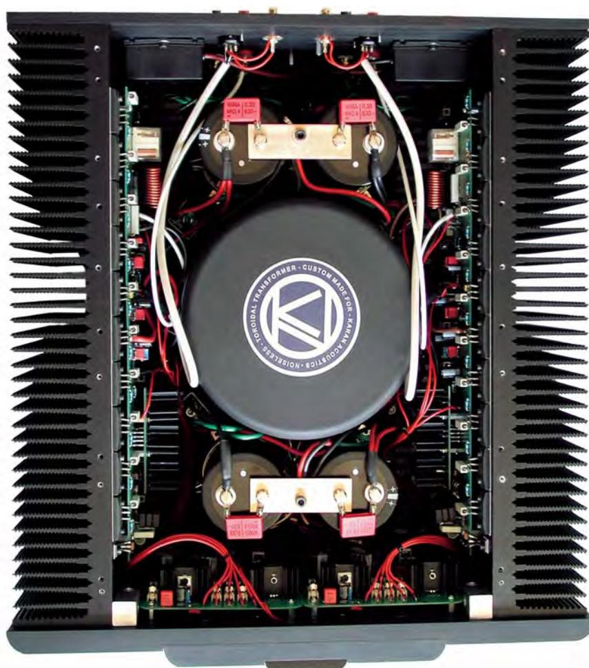
tra-se preenchida por um rendilhado que contribui e muito para aumentar a área de dissipação efectiva. Talvez esteja aqui uma das razões porque um amplificador desta potência praticamente não aquece mesmo após vários dias de funcionamento contínuo.
