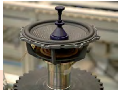
Linha de montagem de um altifalante de médios.
