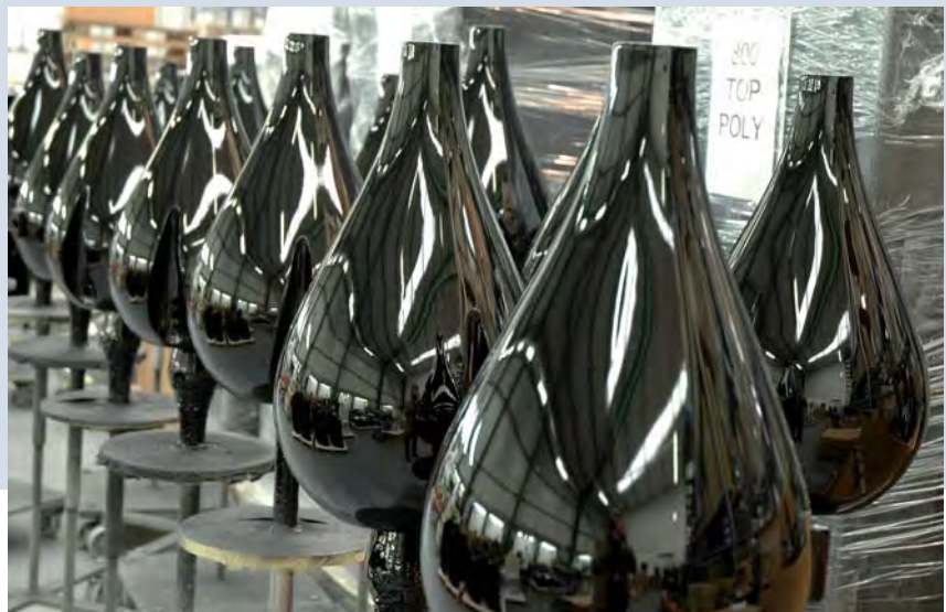
Conjunto de «cabeças» das Diamond na fase final de polimento.
