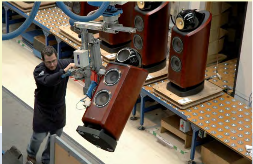
Transporte de um par de Diamond 800 já completamente finalizadas.
