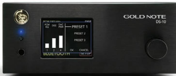
ros com uma resolução máxima de 32 bit a 384 kHz. Todas estas opções são seleccionáveis através do botão rotativo do painel frontal ou do comando remoto.
